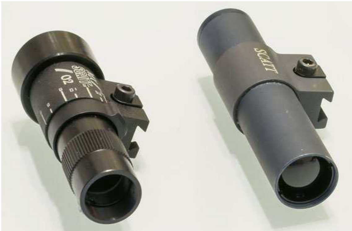
El nuevo sensor MX-02 junto con su antecesor, el basado en infrarrojos
